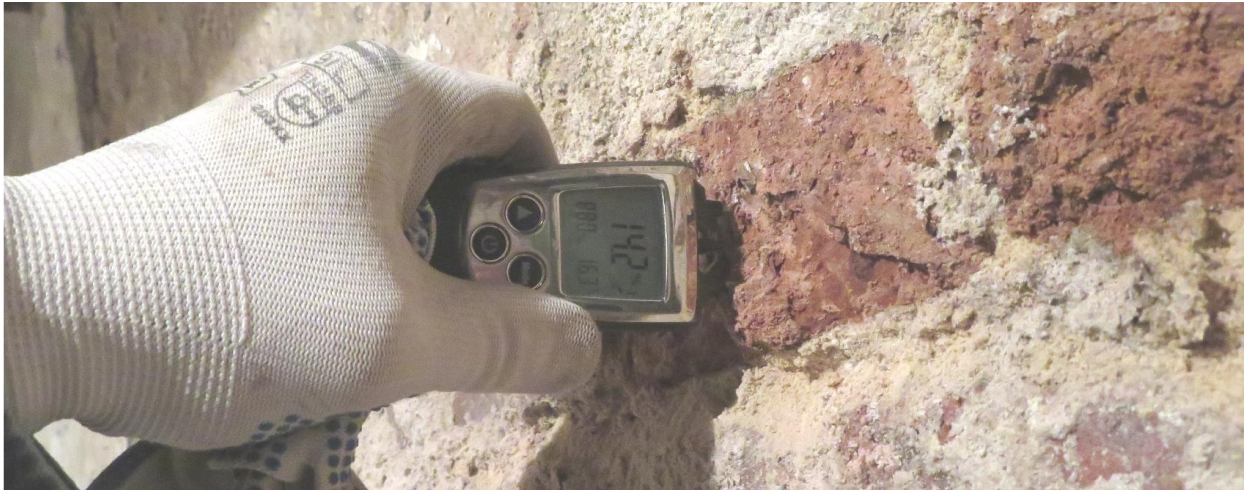
Piwnice w części budynku po widownię , silne zawilgocenie , zacieki , wykwyty solne , korozja wgłębna elementów stalowych
